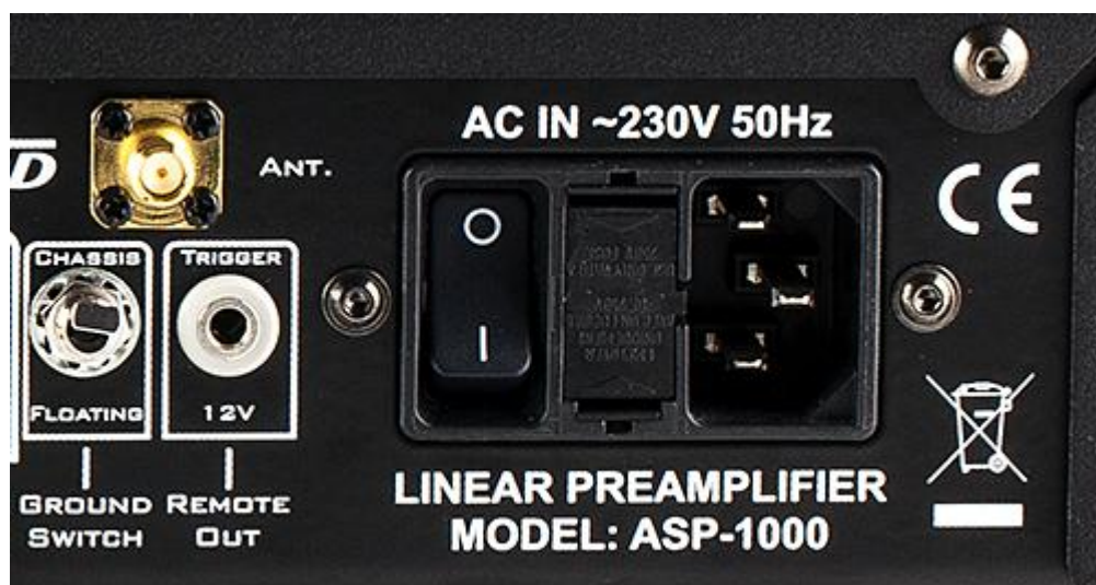
Gniazdo zasilania sieciowego, wyjście „REMOTE OUT” 12V DC oraz odłącznik masy analogowej od uziemienia.
